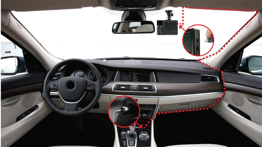
3. Nach dem Starten des Fahrzeugmotors schaltet sich die DrivePro automatisch ein und beginnt mit der Aufzeichnung.
