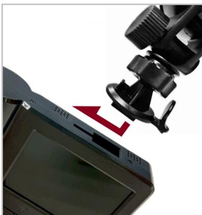
2. Prima dell'installazione, pulire ed asciugare l'area del parabrezza dove si desiderate installare la DrivePro. Se possibile, fissarla al centro del parabrezza vicino allo specchietto retrovisore per avere un migliore campo visivo.
