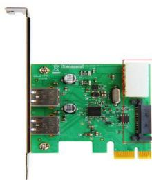
**Le connecteur d'alimentation 4-pin/15-pin DOIT être branché à votre PC pour faire fonctionner vos appareils USB 3.0**
